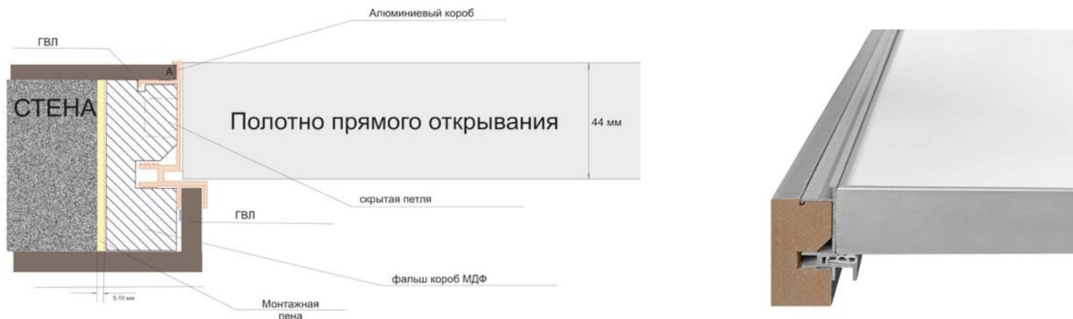
Рис. 2. Коробка для полотен прямого открывания с AL кромкой
